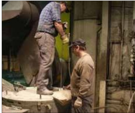
Зафиксируйте тигель смесью для засыпки используя вспомогательный вибратор
