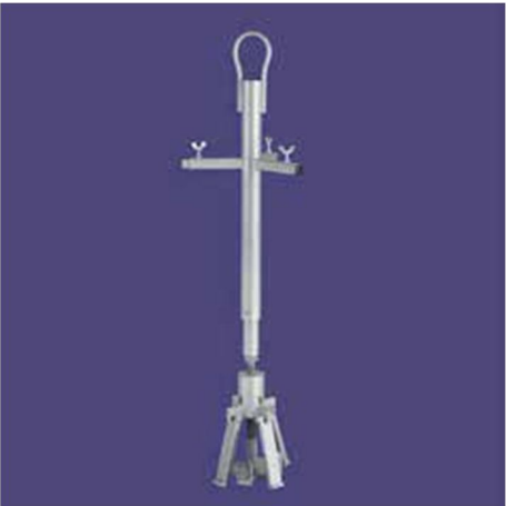
Подъемное устройство для тигля: Этот инструмент м.б. использован для транспортировки и установки готового тигля
