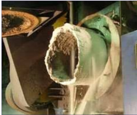
Тигель выдавливается гидравлическим выталкивателем
