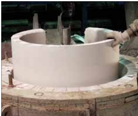
Затем вставьте готовый тигель DORIT с помощью подъемного устройства
