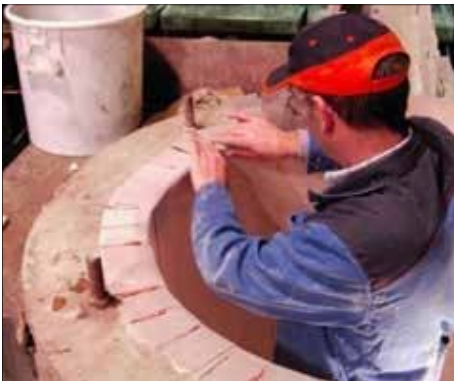
Перед тем как установить готовый тигель DORIT, наклейте изоляцию и насыпьте подушку для тигля
