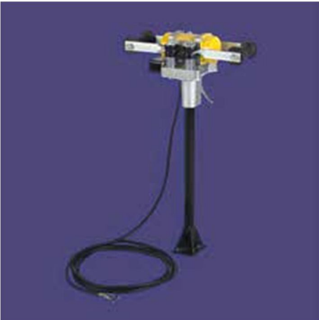
Электрический ручной вибратор: Вибрационный эффект передается на прямоугольную опорную плиту через трубку (длиной не более 1000 мм). Данный инструмент особенно удобен для маленьких печей и для утрамбовки нейтральных и основных сухих масс. Засыпанный слой не должен превышать в высоту 60 мм.
