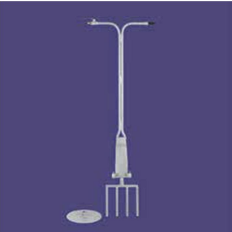
Вибратор на сжатом воздухе: Устройство приводится в действие шаровым воздушным вибратором с высокой частотой и м.б. использовано вместе с вилкой и подовой плитой. Вибратор управляется вручную и особенно удобен для набивки сухих огнеупоров, которые должны быть заполнены слоями 100-120 мм.
