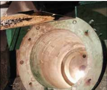
Печь должна быть очищена и обмазка индуктора проверена
