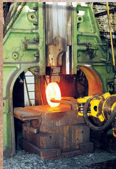
Andromat ® at open die forging Использование Andromat ® при ковке в открытом штампе
