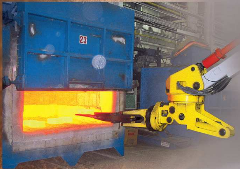
Andromat ® AM 2000 on a ring forging mill Andromat ® AM 2000 на производстве горячекатанных колец
