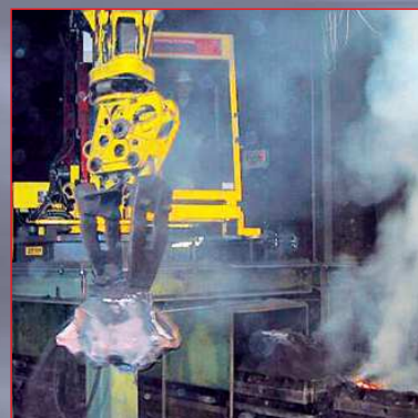
Andromat® AMX 60 unpacking engine blocks Andromat® AMX 60, извлекающий блоки цилиндров из литейных форм
