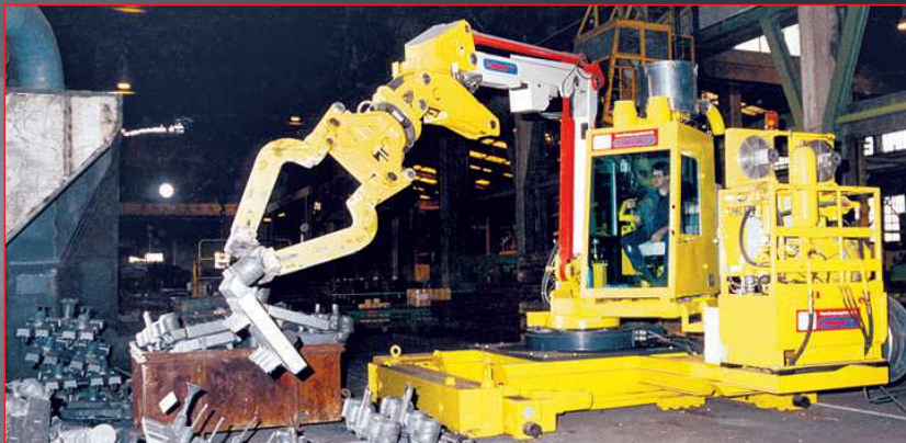
Wheel mounted Andromat® AM 2000 in a foundry Andromat® AM 2000 на колесном шасси, применяемый в литейном производстве
