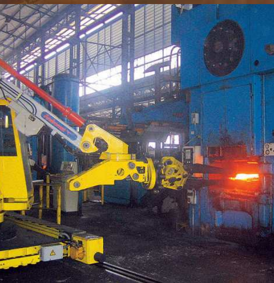
Wheel mounted Andromat ® AMX 40 in a forge Andromat ® AMX 40 на колесном шасси в кузнечном цехе
